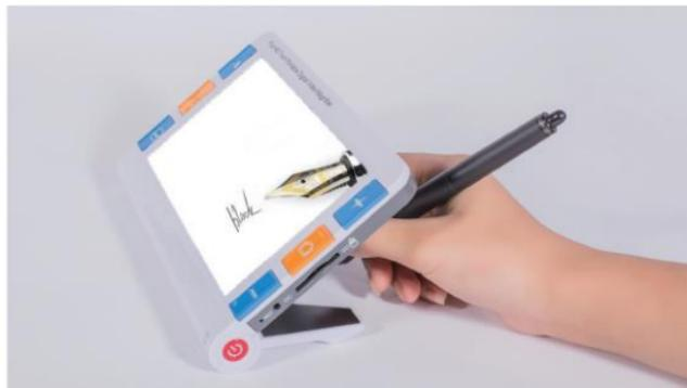
La staffa di supporto inclina il video ingranditore rispetto al tavolo. È una posizione ergonomica. Durante la lettura, il collo si trova in posizione naturale, rilassata e confortevole.
